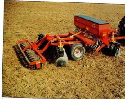
Foto 1: Conjunto DISCODRILL de la empresa francesa RAU que consta de grada de discos, rodillo y sembradora, particularmente indicada para plantación de praderas o para barbechos "verdes".
